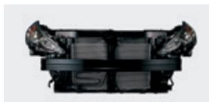
→ 汽车前围模块 车前冷却模块、车灯、保险杠、车架等
