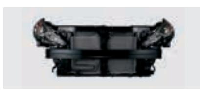
汽车前围模块 车前冷却模块、车灯、保险杠、车架等
