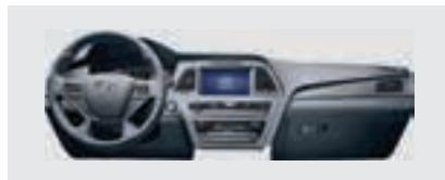
驾驶舱模块 安全气囊、音响/视频、空调/供暖、线束、储物箱
