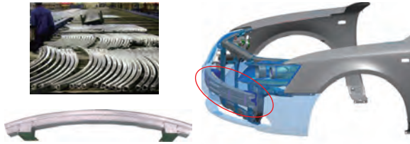
알루미늄 Bumper Back Beam 형상
